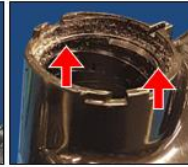
Anneau de retenue de pompe MANQUANT
