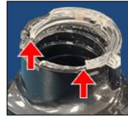
Anneau de retenue de pompe ENDOMMAGÉ
