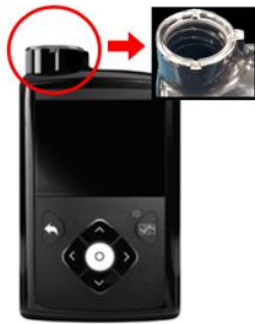
Image : Emplacement de l'anneau de retenue sur la pompe à insuline de la série MiniMed MC 600
